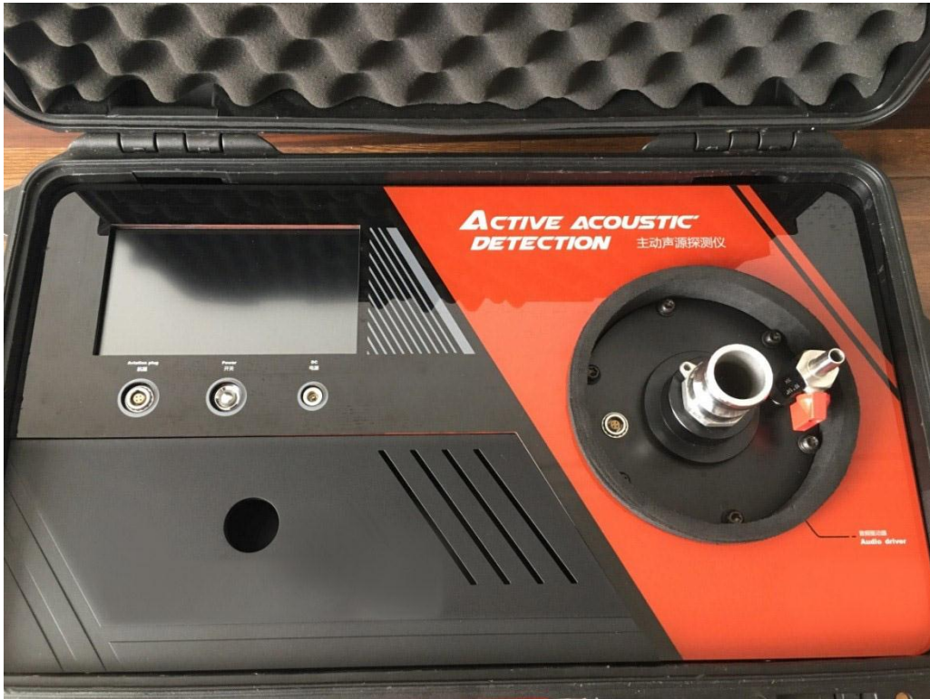
图 1-2 主动声源探测仪发射机
