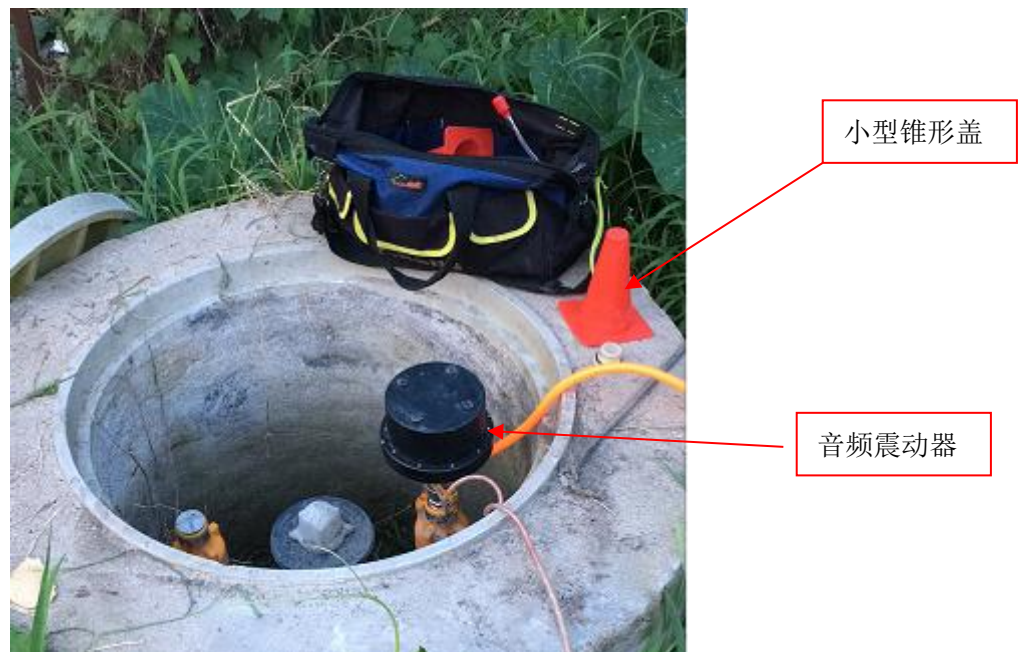
图 2-1 放散口连接方法
